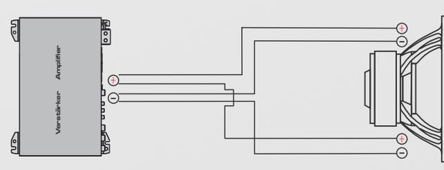
Serial wiring: 4 Ohm
